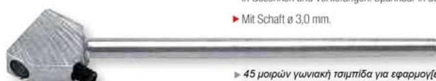
► 45° Winkelklemme zur Aufnahme von Rundmaterial mit 3,0 mm Durchmesser, wie Keramikfaserfeilen, Vulkanfiberstifte und Polierhölzer. Die Winkelklemme eignet sich besonders zum Arbeiten in Gesenken und Vertiefungen. Spannbar in der flex-polí Maschine 610.
