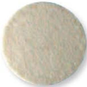
► Polierscheiben aus weißem Wolffilz, zum Aufkleben auf Poliermittelträger, 2 mm dick, ermöglichen in Verbindung mit Diamantpasten einwandfreie Hochglanzpolitur und beste Ausnutzung der Diamantpaste.
