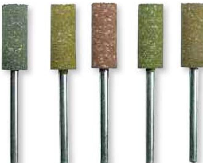
► Die gummibundenen Schleif- und Polierkörper in der Abmessung ø 3 x 7 mm eignen sich besonders zur Bearbeitung kleinster Flächen und Bohrungen. Zur Aufnahme des Schaftes ø 1,6 mm in 3 mm Spannzangen steht der Adapter Nr. 620 725 zur Verfügung.
