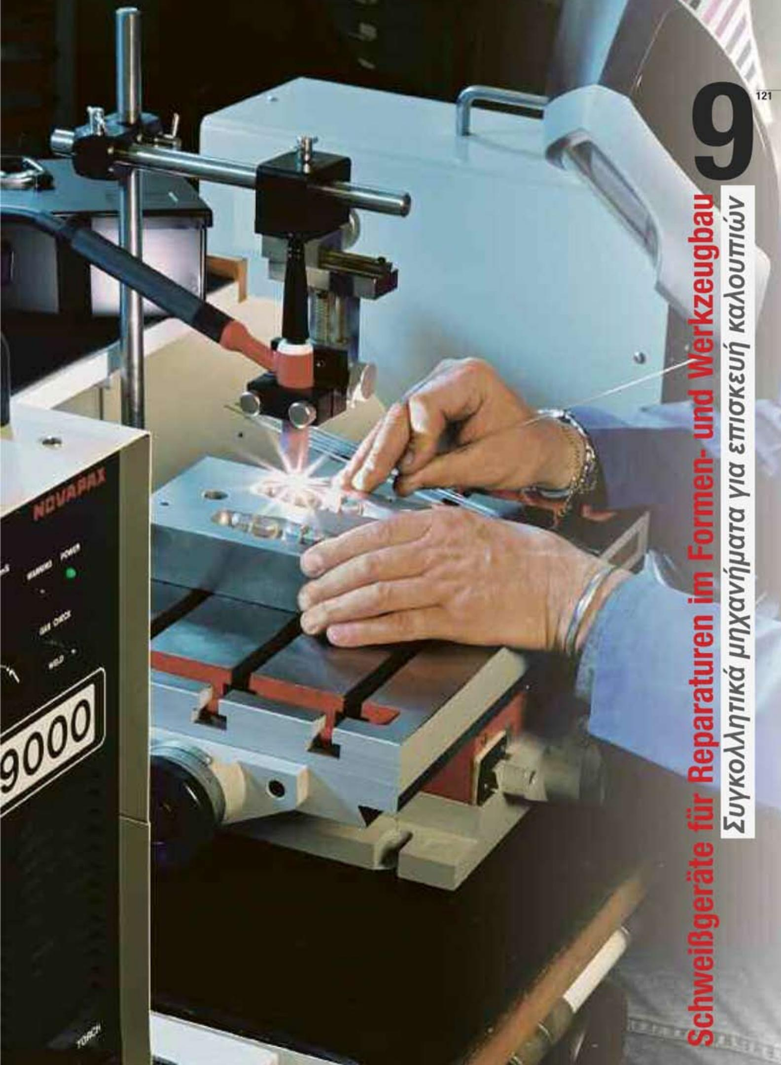
Schweißgeräte für Reparaturen im Formen- und Werkzeugbau
