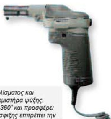
► Luftgekühltes Schleif- und Feilhandstück mit um 360° drehbarem Feilkopf. Kopf bei Bedarf arretierbar. Kurzer Hub und hohe Geschwindigkeit für kleine Flächen besonders geeignet. Werkzeugaufnahme für Ø 2,0 - 6,35 mm.
