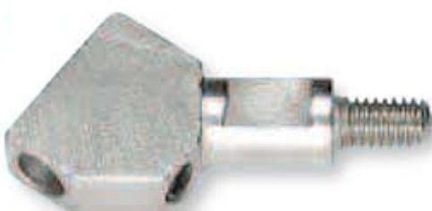
► 45° Winkelklemme zur Aufnahme von Rundmaterial mit 3,0 mm Durchmesser, wie Keramikfaserfeilen, Vulkanfiberstifte und Polierhölzer. Die Winkelklemme eignet sich besonders zum Arbeiten in Gesenken und Vertiefungen.
