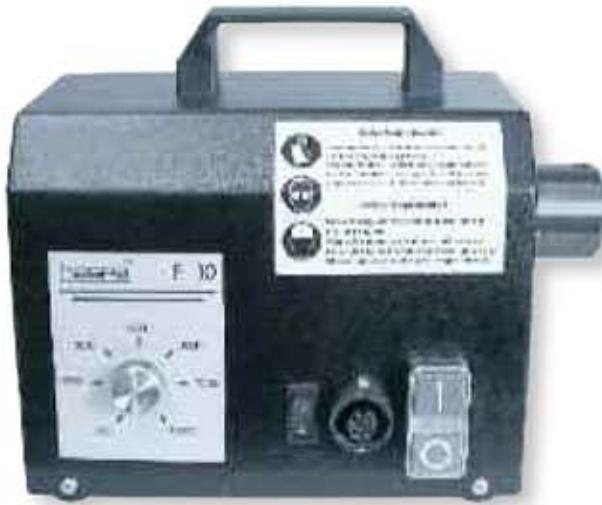
► Stufenlos regelbarer Antrieb von 800-10.000 min<sup>-1</sup> mit Überlastungsschutz. Anschluss für Arbeitswellen M10 DIN 30, solide Bauart. Schutzart gem. VDE 0100, IP 54 DIN 40050, mit Tragegriff, Farbe: Schwarz. Vorbereitet für Fußregelung.
