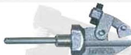
► Klemme aus rostfreiem Präzisionsstahlguß zum Spannen von Flach- und Rundmaterial kleinster Abmessungen aus Keramikfaser, Vulkanfiber, Polierhölzer und Messing. Die Universalklemme wird in die flex-polí Maschine 610 oder in die Handgriffe 610 817 und 610 818 eingespannt.
