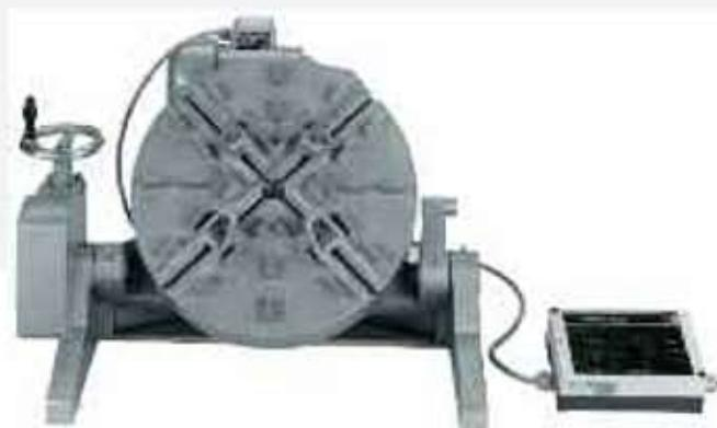
► Zur speziellen Bearbeitung von runden Innen- und Außenkonturen ist der Spanntisch 602/D mit einer elektrisch angetriebenen Planscheibe Ø 400 mm ausgerüstet. Die Planscheibe ist um 90° schwenkbar. Die Drehzahl wird über einen Drehzahlregler im Bereich 3 min<sup>-1</sup> - 50 min<sup>-1</sup> geregelt.
