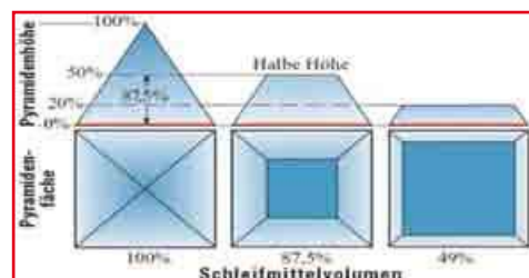
Schleifverhalten bei Hülsen mit Trizact™ grinding behaviour of spirabands with Trizact™
