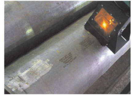
Beschriftung von Stahlrohren
